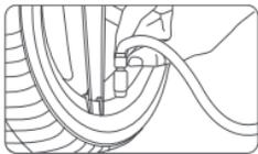
2. 通电状态下，按下充气开关到“—”位置，即可开始充气。如果短时间气压表指针指示数值迅速变化（3秒上升超50 psi），表示空气气压受阻，请立即关闭电源，从轮胎气嘴上取下旋口式气管接头，重新连接气管。
