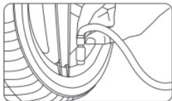
2. Encienda el dispositivo y ponga el interruptor de encendido/apagado en la posición « $\longleftrightarrow$ » para empezar a bombear. Si la presión de la válvula de gas aumenta rápidamente en un intervalo de tiempo corto (50 psi en 3 segundos), esto significa que el paso de aire está obstruido. Apague inmediatamente la alimentación eléctrica, desconecte el conector de gas del roscado de la boquilla del neumático y vuelva a conectar el tubo de gas.
