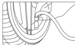
2. Чтобы начать процедуру накачивания, включите компрессор, установив выключатель электропитания в положение «←». Быстрое увеличение давления воздушного клапана за короткий промежуток времени (50 фунтов на кв. дюйм за 3 секунды) говорит о том, что засорен воздушный канал. В этом случае следует немедленно выключить электропитание, отсоединить навинчивающийся воздушный соединитель от штуцера шины и снова подсоединить воздушный шланг.
